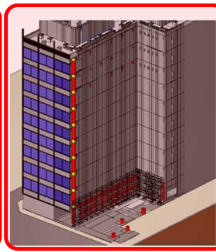
3. 既存外壁 (ECP)解体
