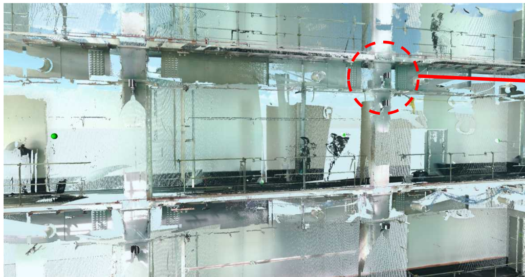
既存鉄骨のデジタル測量結果(点群)
