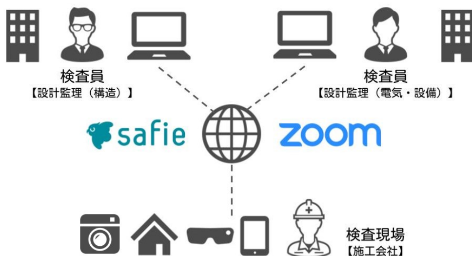
配筋検査概念図
