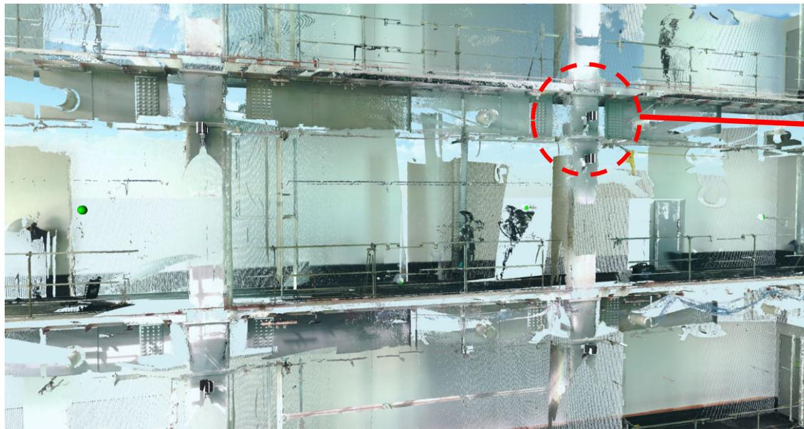
既存鉄骨のデジタル測量結果 (点群)
