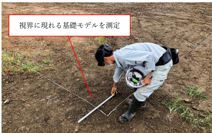
縄張りとの比較による BIM モデルの AR 投影精度の確認状況
