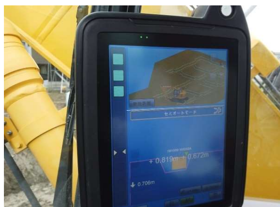
ICT 重機での半自動掘削状況
