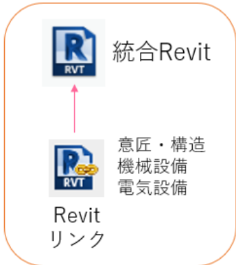
図表 3-4 設計モデルから総合図を作成
