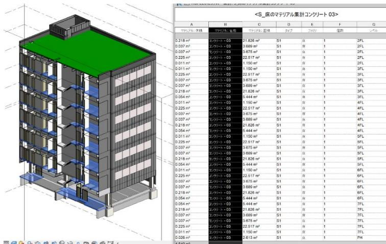
図 36 コンクリート工事の算出方法
