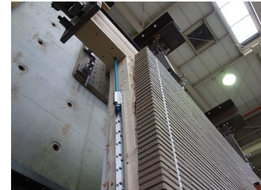
屋外側 構造用合板 くぎのパンチングアウト
