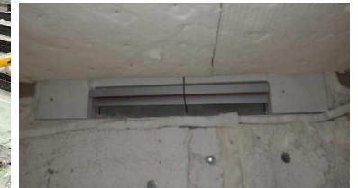
炉内・試験体下部 通気口(No1)
