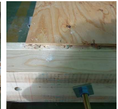
屋外側 構造用合板 加力側脚部状況
