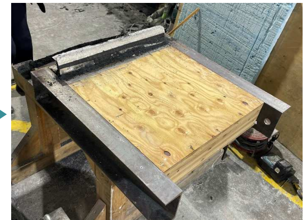
燃焼後・構造用合板の屋外側表面(No3)
