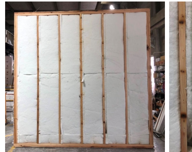
②試験体 試験後 木製下地
