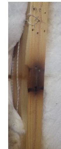
⑥試験体 試験後 木製下地
