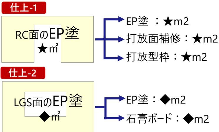
表面仕上が同じでも、仕上を貼る壁の種類によって下地の構成が異なる。
