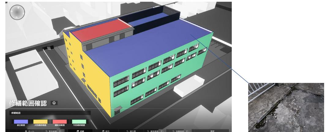
BIMモデルを用いることで計画内容の伝達がより円滑に行えると思われる。劣化状況写真をモデル情報と連携させることでの理解度を高めることへも貢献できる。
