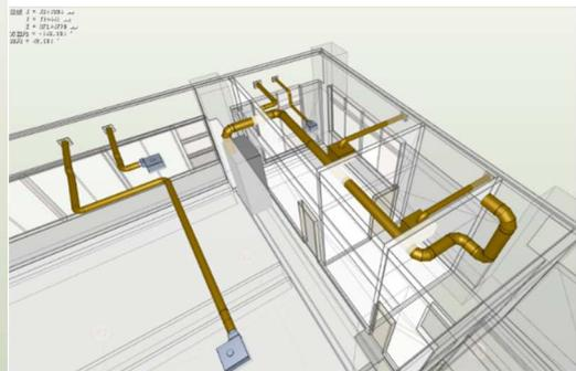
図 3-3-9. BIMによる換気設備図-2
