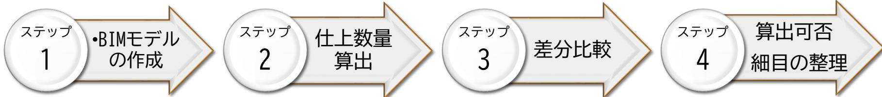
数量算出に必要な部材（材料）を漏れなく効率的にモデリングするワークフローを策定し、BIM意匠モデルを完成させる。
