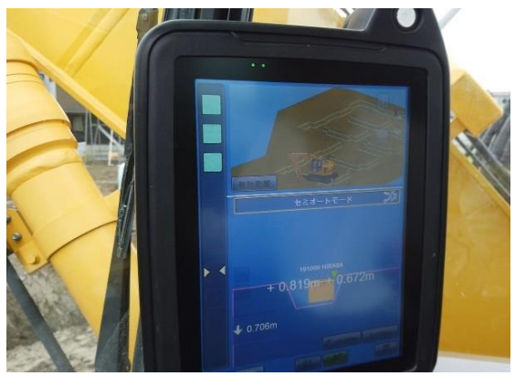
ICT重機が自動で掘削位置と深さを認識する。
