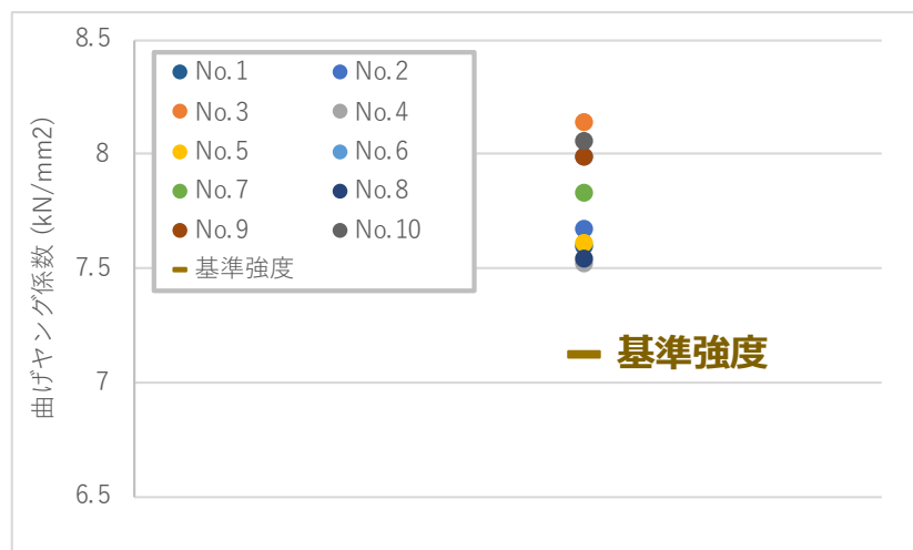
① 面外曲げ試験 (曲げヤング係数)
