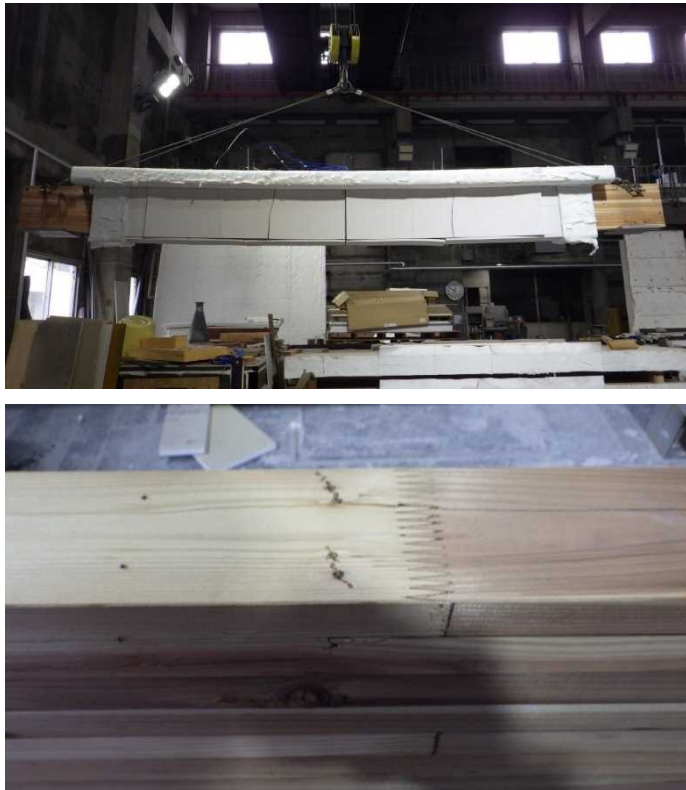
120-No.5 試験後 破壊部分の状況
