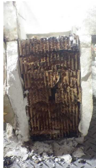
90-No.1 試験後 破壊部分の状況
