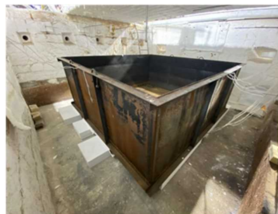
炉内の鋼製パン
