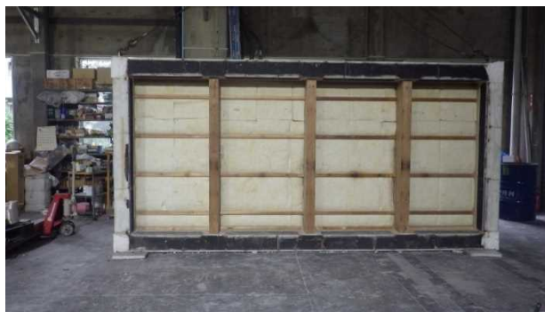
試験後の床組みの例 90-No.1 変色、NGあり
