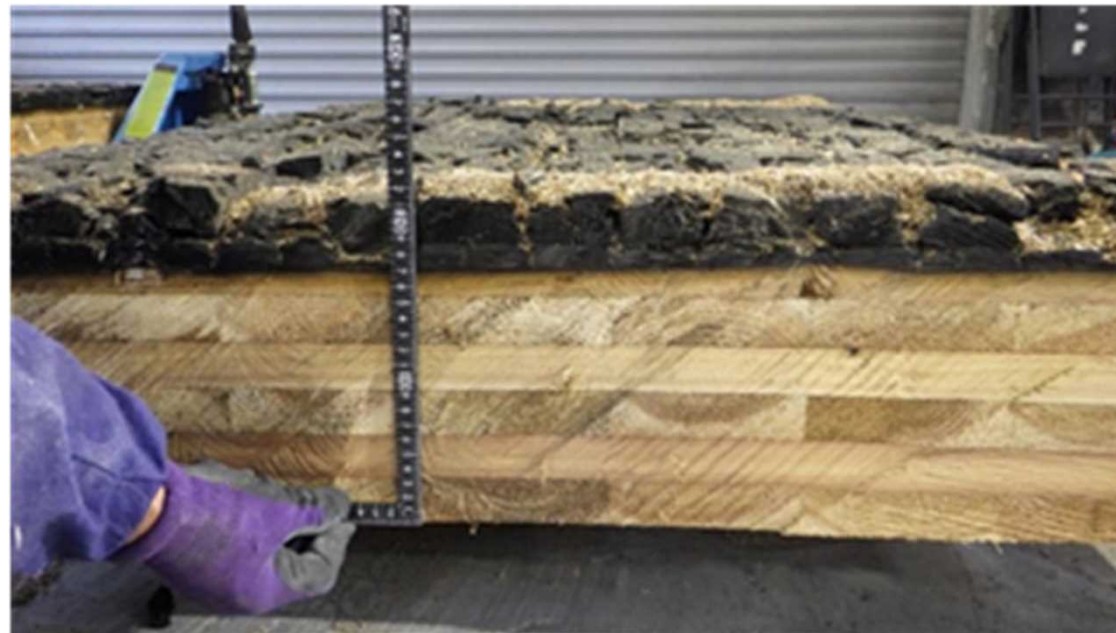
加熱後の試験体の状況
