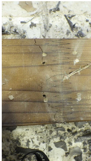
120-No.2 試験後 破壊部分の状況
