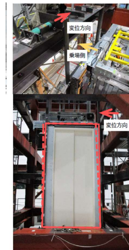
図2.2.2 乗場三方枠へ強制変位を与えた場合の戸開閉動作確認
