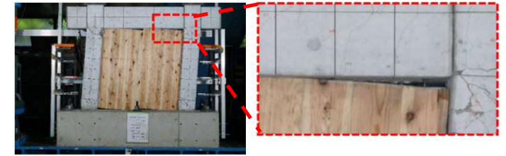
図5.5 層間変形角6%における変形性状 (CTL耐震壁(WF))
