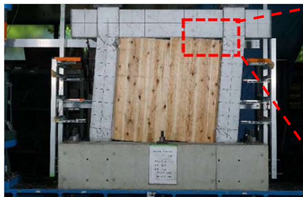
図5.5 層間変形角6%における変形性状(CLT耐震壁 (WF))
