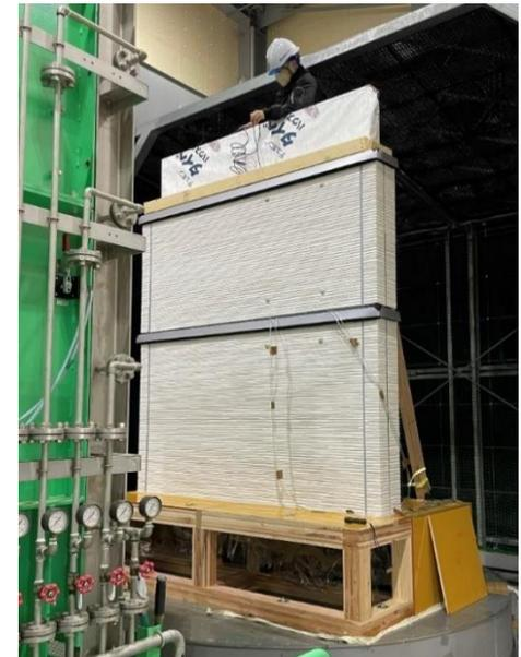
内視鏡を用いた通気層内への水の吹き上げ観察
