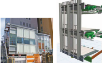
▲従来のモックアップ(左)とデジタルモックアップ(右) 出典:『施工BIMのすすめ 成功につながるBIMスタートアップガイド2017』P.17
