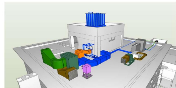
屋上 高架水槽、換気設備などの外観
