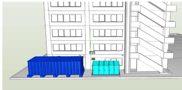
受水槽及びキュービクルの外観
