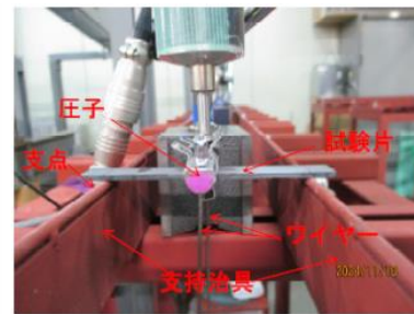
曲げDOL試験 (CFRP)
