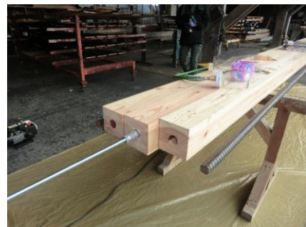
鉄筋孔の目荒らし
