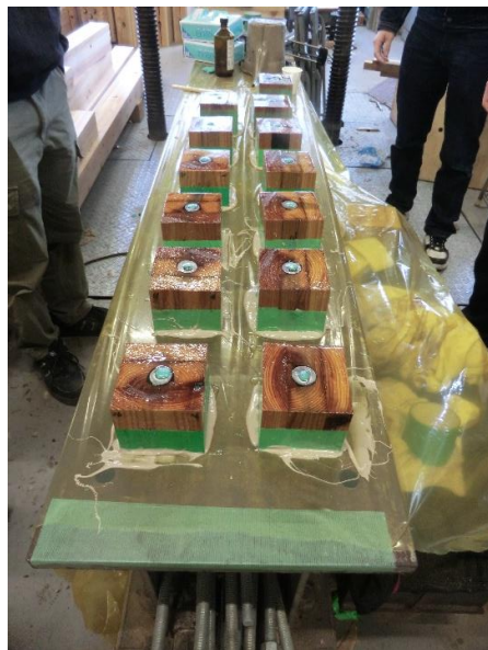
長さ9cmに切断後、 含水率を一定にするため エポキシ接着剤コーティング 底面は粘性の高いエポキシ 接着剤でキャピング
