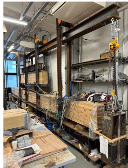
実大鉄筋集成材の梁1体の長期載荷 断面: 210x502mm, スパン: 8.91m 2023.12-現在も計測中(1年5ヵ月)
