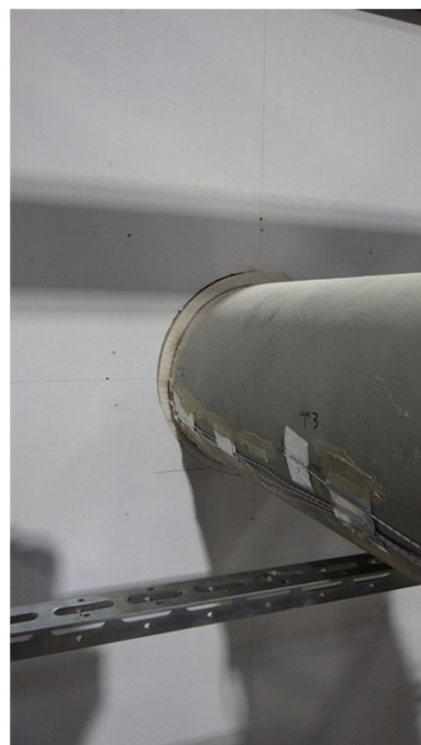
中実壁 2時間加熱試験後 クリアランス15mm 加熱側／非加熱側
