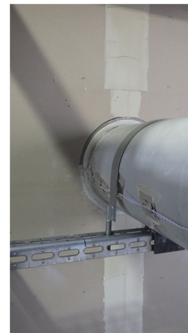
中空壁 2時間加熱試験後 クリアランス100mm 加熱側／非加熱側
