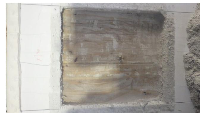
厚さ65mm 試験後CLT表面
