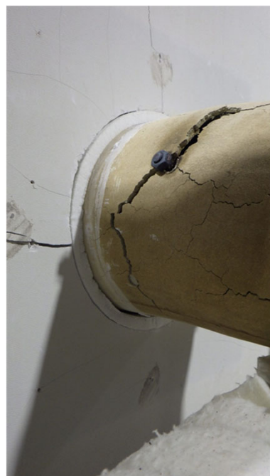
中実壁 2時間加熱試験後 クリアランス15mm 加熱側／非加熱側
