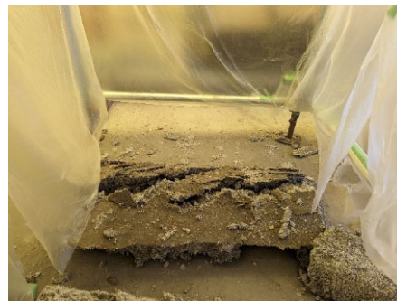
A-1 (表面処理なし、脱落防止措置なし) の脱落の様子
