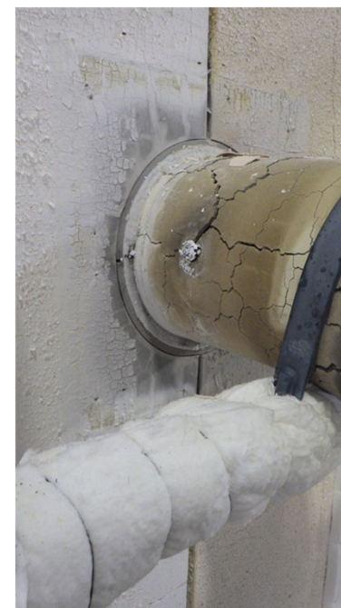
中空壁 2時間加熱試験後 クリアランス100mm 加熱側／非加熱側
