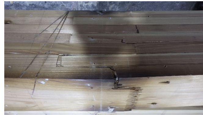
破壊した試験体の様子 (幅150mm : No.A-R6-2-120)
