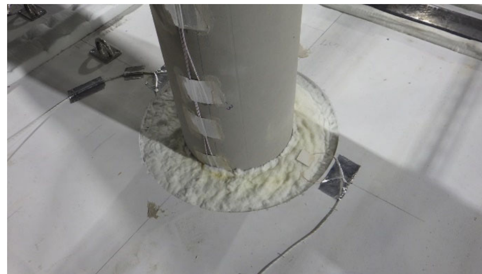
2時間加熱試験後 クリアランス100mm
