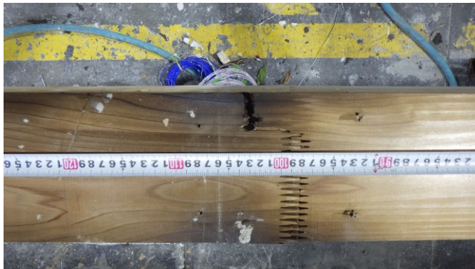
破壊した試験体の様子 (幅150mm : No.A-R6-2-120)
