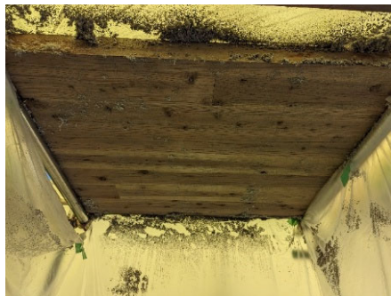
A-1 (表面処理なし、脱落防止措置なし) の脱落の様子
