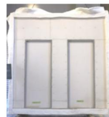
戸の部分に 遮熱性を有する防火設備
