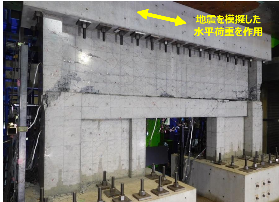
RC造の連層耐力壁の載荷実験
