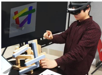
統合的な情報技術支援による組み立て作業のモデル実験 Timber Bonsai Workshop
