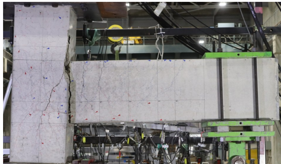
BCJ1-HDG 梁降伏型破壊 (正载荷) 接合部降伏型破壊 (負载荷) 29
