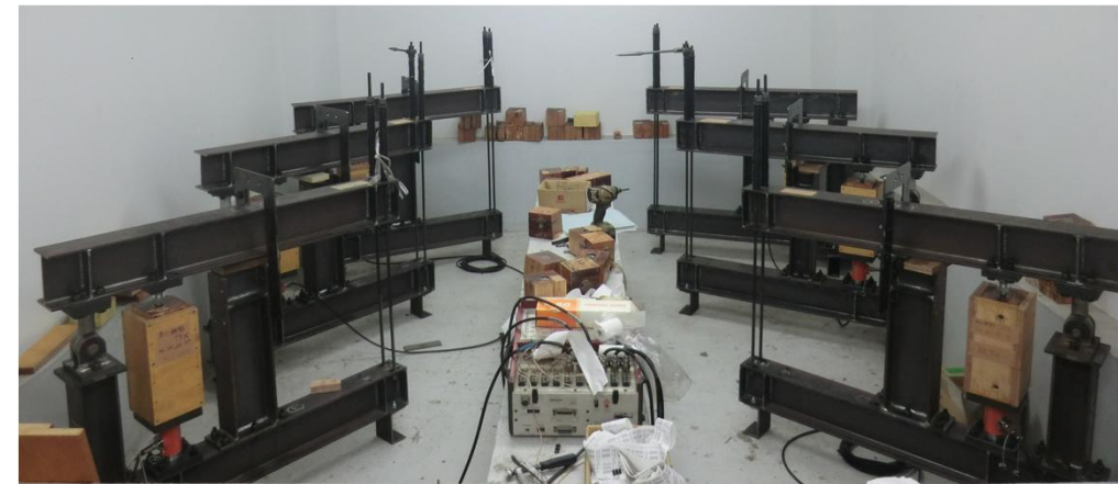
恒温室に設置された6台の加力装置
