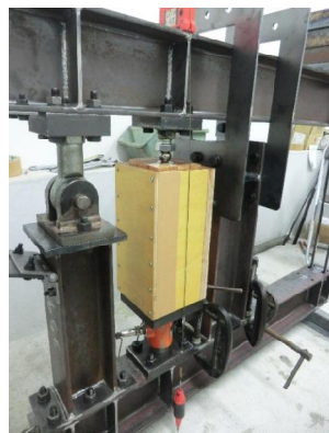
ビスによる角形合板 圧縮加力を安定させる
