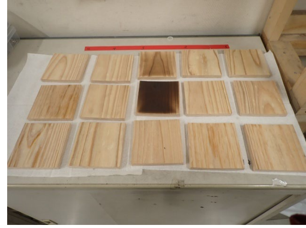
加熱後 杉板の状況 最高受熱量
