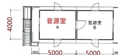
床CLT厚210mm / 音源室・受音室：4m×5m×h3.0m
