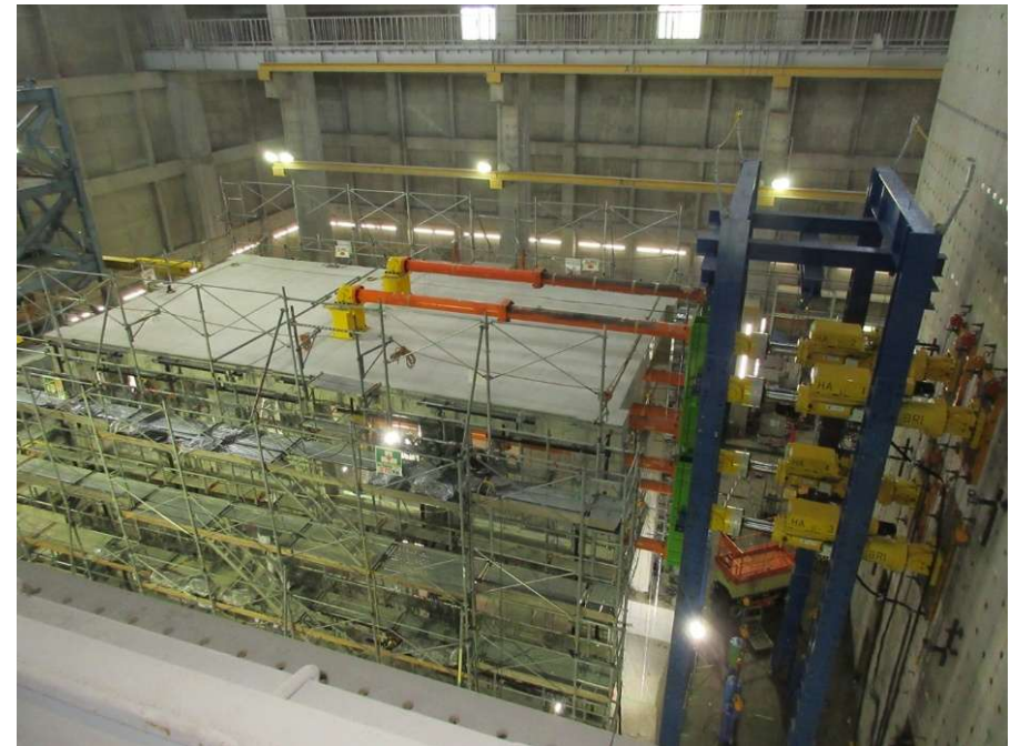
架構試験体の形状と加力装置(4本のアクチュエータで水平加力を行う)
