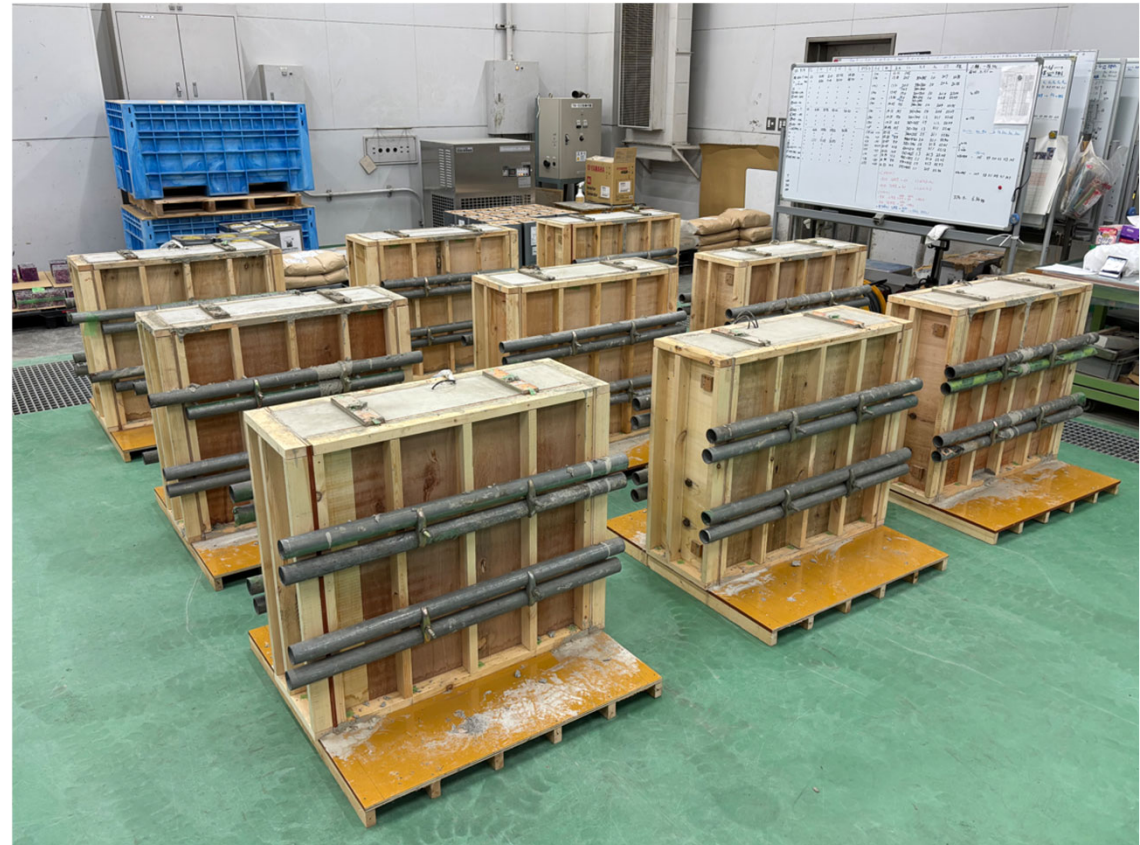
打設後の試験体
