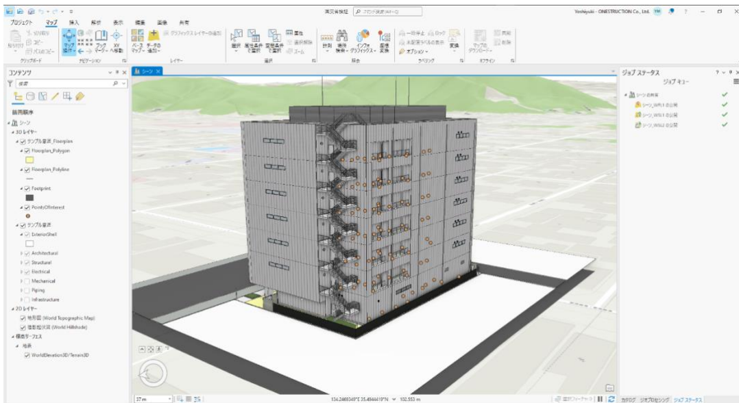
図 3.PC 型 GIS ソフトで Revit 形式の BIM モデルを取り込んだ画面
