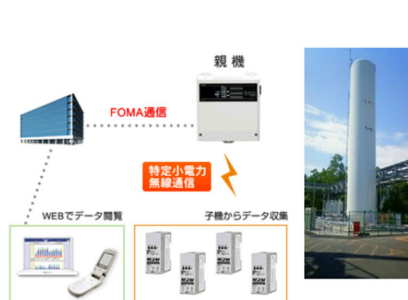
LNGサテライト基地遠隔監視システム (液面高・圧力等)
