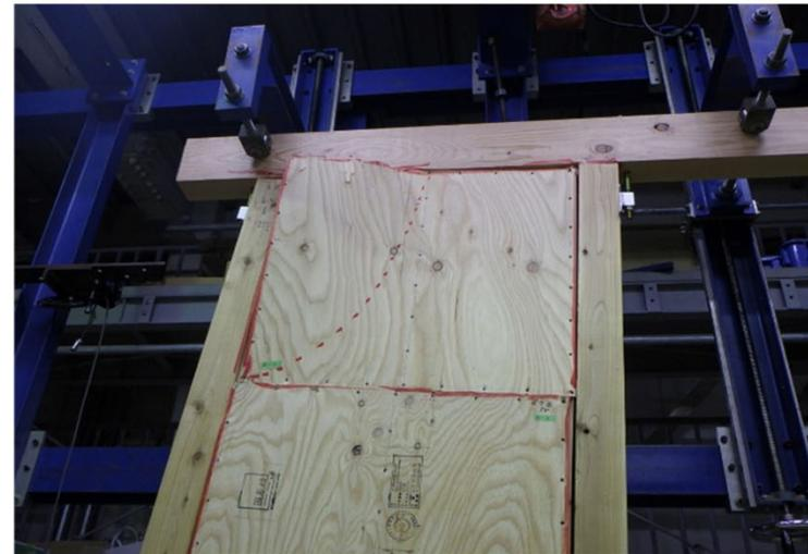
桁側の面材の座屈（例：B-3-1 1/12.5rad 時）
