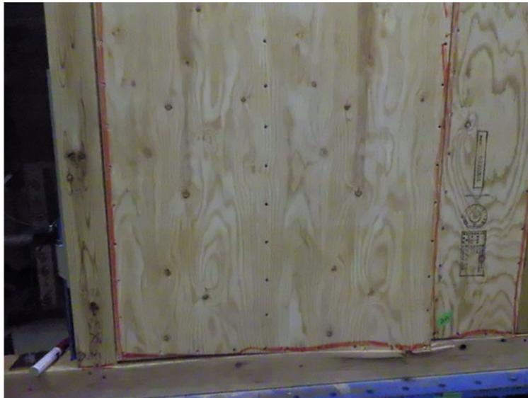
面材と土台の接触（例：A-4-3 1/14rad 時）
