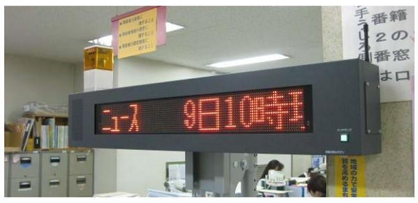
・LED電光表示板（上部に設けられているのは、緊急情報の表示と連動した回転灯とニュースや緊急情報を受信するアンテナ）
