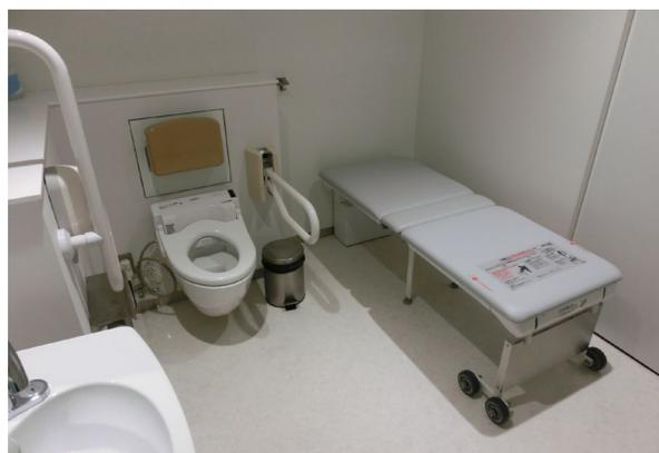
・短辺方向に折り畳む大型ベッド（使用時）
