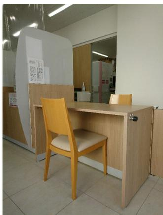
・薬局に設けられたローカウンター（下端高さ：73cm、上端高さ：76cm）
