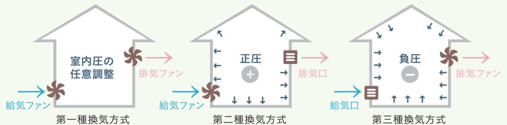
機械換気は、第一種換気方式、第二種換気方式、第三種換気方式に分類されます。
