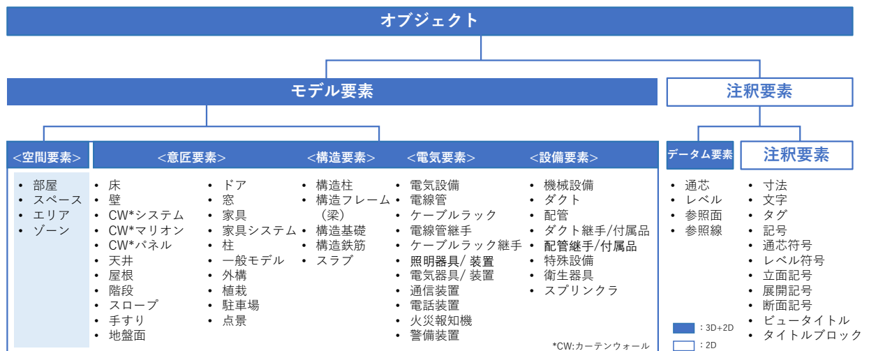
図 5-1 オブジェクト構成 (Autodesk Revit®の例)
