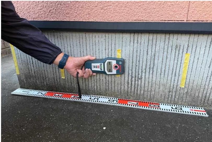
(有筋の場合、反応した位置 (赤いランプ) から配筋間隔を計測)
