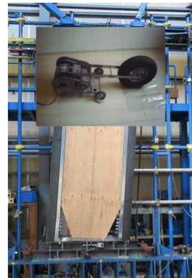
高減衰型摩擦機構内蔵耐力壁
