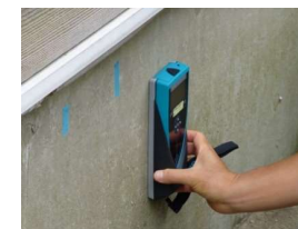
基礎配筋の調査
