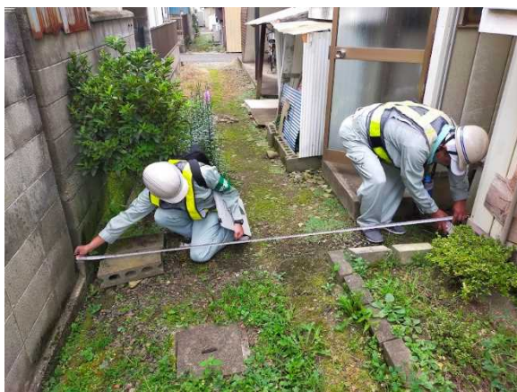
写真3 共用通路の幅員調査
