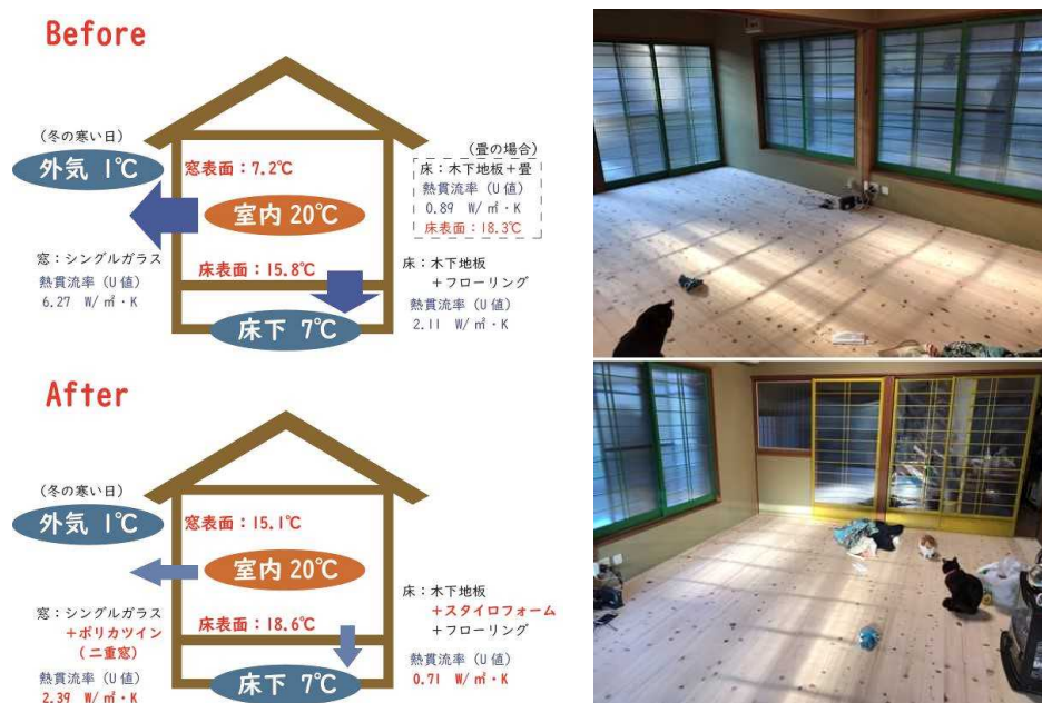
図 3-2 各表面温度の改修前後の予測値と完成写真
