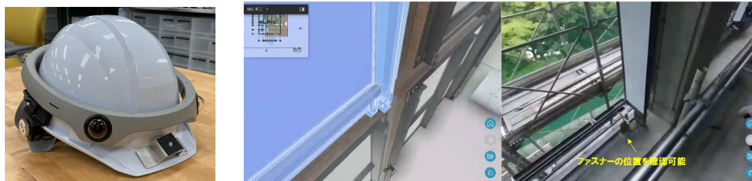
図 成果物（左：独立 4 眼型の試作機、右：360 度画像と BIM 比較機能のデモ）
