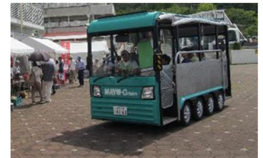
低速電動バス(eCOM-8) ・最高速度19km/h ・燃料: 電気10人乗り
