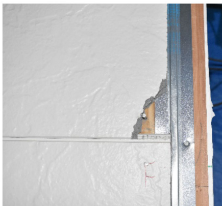
(a) 釘留め・ 1/50\text{ rad} 経験後 (釘接合部から角欠け)
