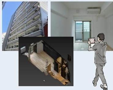
①現地調査にて汎用的デバイスを用いたLiDAR測量を行い室内を3Dデータ化する
