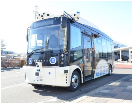
ティアフォー製Minibusを用いた 一般公道混在空間におけるレベル4走行
