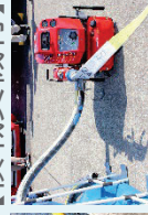
可搬式ポンプ
