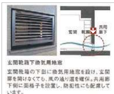
集合住宅の住戸の玄関収納下の地窓。プライバシー、防犯性に配慮して通風を確保（写真：③）
