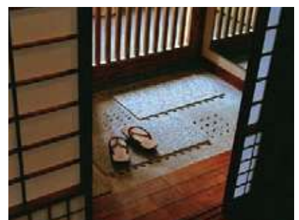
集合住宅の居室とバルコニーのあいだに土間風の中間領域を設け、建具で仕切り熱の移動を調節（写真：①）
