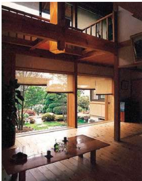
室内にすだれを吊るし、日射の流入を抑制。見た目にも涼感と風情が感じられる (写真：①)
