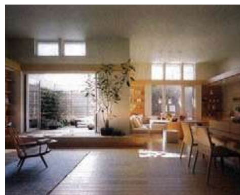
通常の天井高さで内法の上部が開口となっている高窓の例（写真：④）
