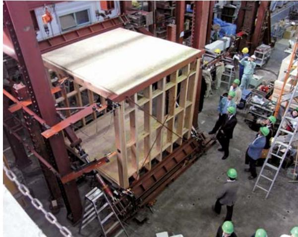
耐震シェルターの斜め加力実験（写真上）と鉛直加力実験（写真右）
