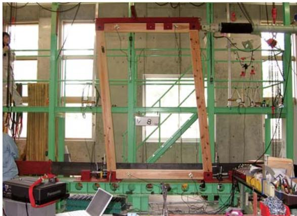
杉材を使ったリブフレームの破壊試験（福山大学にて）
